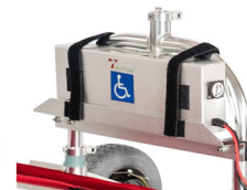
Soporte de batería elevado
