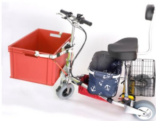
11.) Levante la caja sobre la **plataforma de almacenamiento (A)** de forma que la marca quede alineada con la columna de dirección, coloque las **correas (G)** alrededor del **separador Omega (C)** y fíjelas, apriete firmemente los tensores de las correas. Fije las dos resistentes **correas de equipaje (H)** a la caja y al soporte del bastón o la muleta. Estos actúan como amortiguadores de inclinación.
